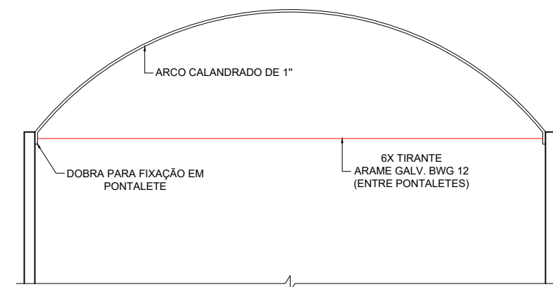
01 DETALHE LIGAÇÃO DO TIRANTE ESKALA: 1/50
